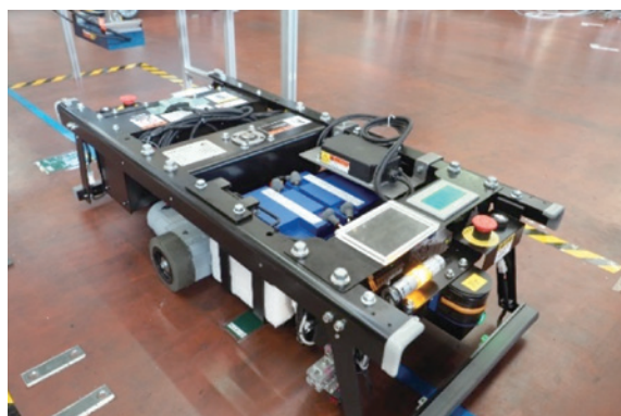
ALM ® （青色）と無線給電の組合せ（小型AGV）
