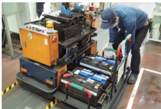
既存AGVの鉛蓄電池をALM ® （青色）に交換中
